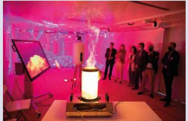
Presentamos un vídeo de impacto de incendios, en segundo lugar pueden ver cómo explota en un tubo de Hartmann un polvo que en condiciones de suspensión y un punto de ignición pueden generar una explosión y un posterior incendio en una empresa.
